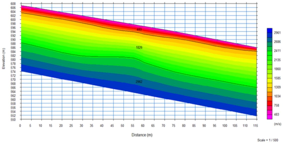
Fig. 8. Seismic cross section N 2.
